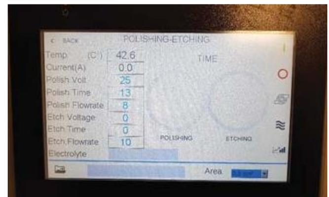
Параметры электрополировки и тип электролита можно увидеть ниже:
