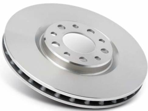
Тормозные диски для мотоциклов, велосипедов и многих автомобилей часто имеют отверстия или пазы, прорезанные через диск. Это делается для лучшего рассеивания тепла, для облегчения рассеивания поверхностной воды, для уменьшения шума, для уменьшения массы или с эстетической целью.
