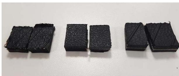
3 образца будут смонтированы с помощью расходных материалов для холодной заливки DMT 35
