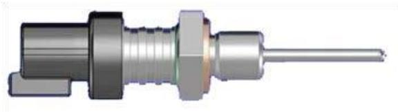
Датчик фактически не измеряет концентрацию кислорода, а скорее разницу между количеством кислорода в выхлопном газе и количеством кислорода в воздухе. Богатая смесь вызывает потребность в кислороде. Это требование вызывает нарастание напряжения, вызванного транспортировкой ионов кислорода через слой датчика. Бедная смесь вызывает низкое напряжение, так как имеется избыток кислорода.
