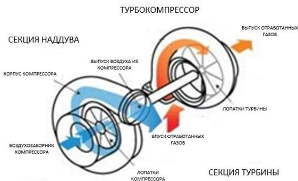
Турбокомпрессоры обычно используются на двигателях грузовых автомобилей, легковых автомобилей, поездов, самолетов и строительной техники. Они чаще всего используются с циклом Отто и дизельными двигателями внутреннего сгорания. Они также нашли применение в автомобильных топливных элементах. В этом разделе часть турбокомпрессора будет отрезана по заданной линии резки.
